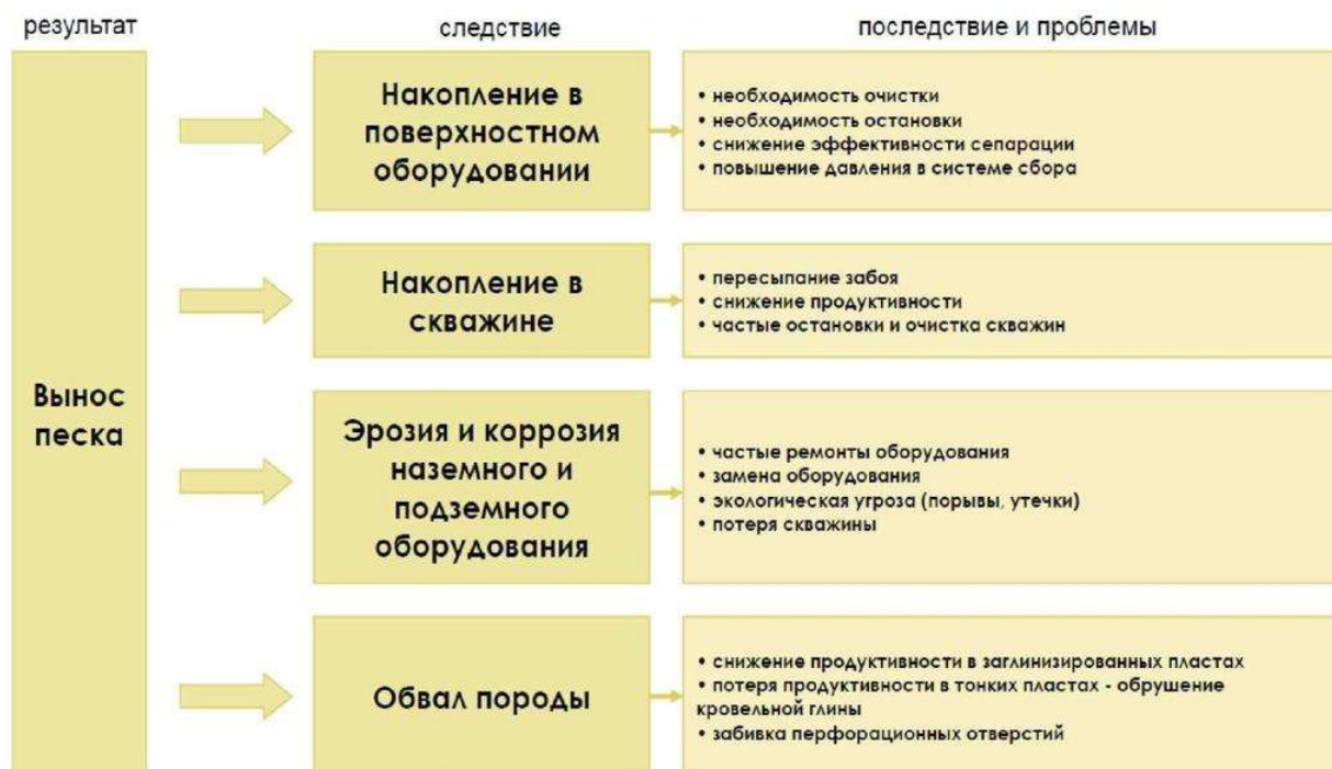
Рисунок 5 – Последствия выноса песка [9].
